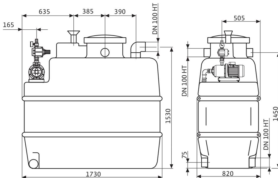
Размеры и габаритные чертежи: Wilo-RWN 1500 AU-MC 304
