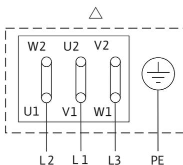
Δ: Схема соединения – треугольник
